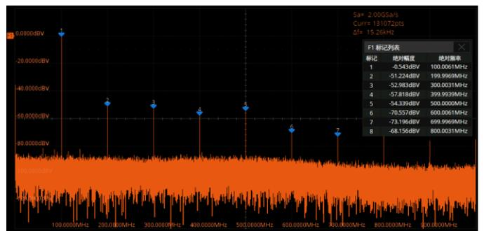
通过硬件加速的 FFT 功能，最大运算点数为 2M 点，在提供卓越的频谱分辨率的同时，仍然能够保持较高的频谱刷新率。支持多种窗函数，支持普通、平均、最大值保持等模式，支持自动标记峰值点
